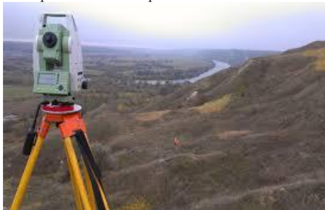
Рисунок 6 - Электронный тахеометр TCR 407 во время съемки работ
